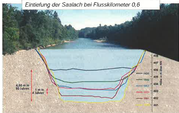
In einem Zeitraum von 80 Jahren (1920 bis 1999) tiefte sich die Saalach um 4,50 Meter ein. Ursachen sind die Begradigung der Saalach und der Rückhalt von Geschiebe in Kibling
