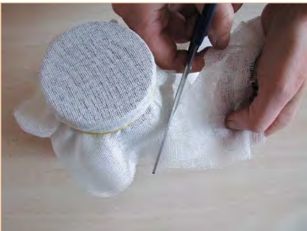
Abb. 21: Verschließen des äußeren Glases mittels luftdurchlässigen Stoffes.
