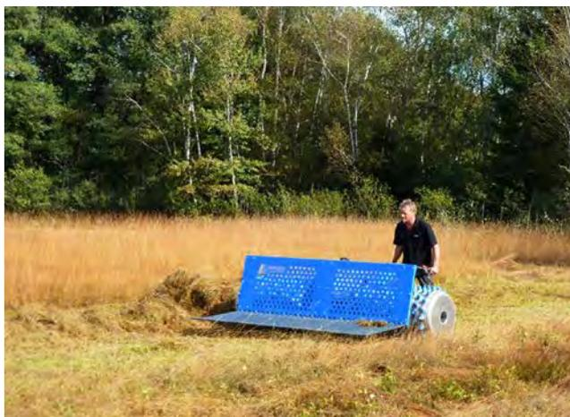
Abb. 7: Neu entwickelte Techniken ermöglichen die effizientere Bewirtschaftung von Nasswiesen. Beispielsweise montierbare Räumschilde/Heuschieber und funkferngesteuerte Balkenmäher mit einer Arbeitsbreite von bis zu sieben Metern ermöglichen die Bewirtschaftung selbst von kaum noch begeharen Feuchflächen (Fotos: Uwe Kießling).
