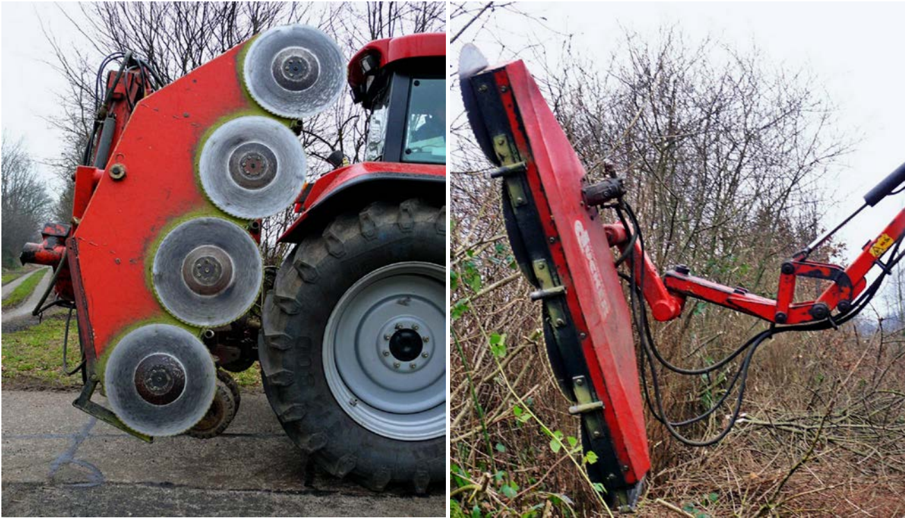
Abb. 6: An Auslegern angebrachte Lichtraum-Profilschneider ermöglichen einen schonenden, flexiblen Rückschnitt von Gehölzen. Fig. 6: Circular saws fixed to tractor booms allow profile cutting that respects nature conservation.
