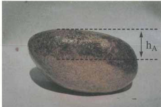
Abbildung 3 b Erfassung der für das vorgestellte Modell relevanten Sohlrauheit anhand der Höhe des Algenaufwuchses h_A .
