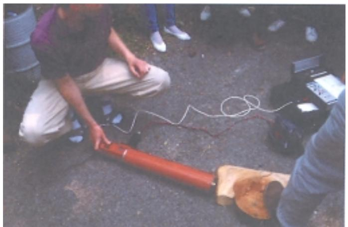
**Foto 22:** Messung des Boden-Eindringwiderstandes (Verdichtungsgrades) mit dem Densitomat
