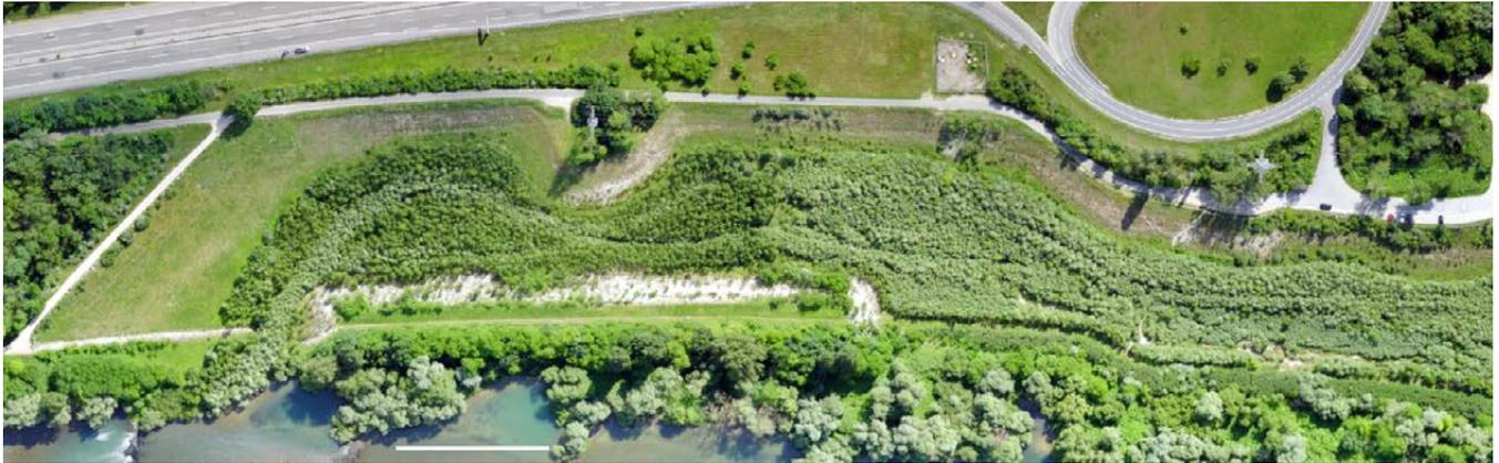
liche Abflussverzögerung im Rheinbett. Die bremsende Wirkung der Vegetation ist Voraussetzung für die Erreichung der vollen Rückhalte- und Dämpfungswirkung einer Hochwasserwelle.
