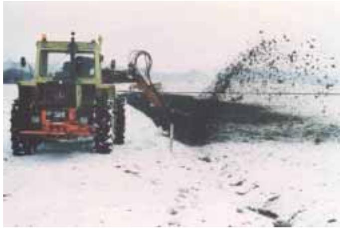
**Foto 8:** (zu [Kap. 2.1.2.4](#)): Profilaufweitung eines Grabens beim Mesnerbichl/STA. Der Lebensraum für die grabentypische Flora und Fauna wurde vergrößert, der Wasserabfluß vermindert (Foto: SCHWAB 7/1991).
