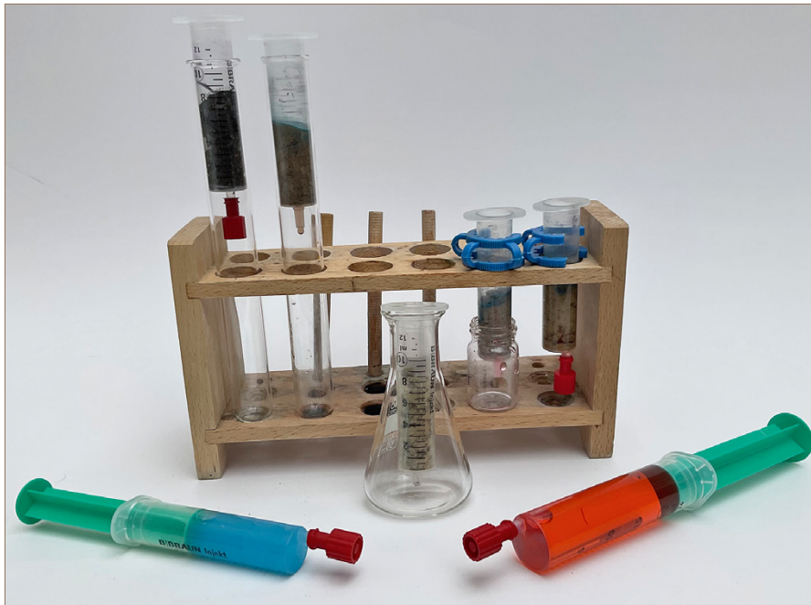
Abbildung B 1-2 Verschiedene Microscale-Aufbauten zur Wasserhaltefähigkeit beziehungsweise Filterfunktion von Böden; vorne links: Wasserfarbensuspension; sehr verdünnte Methylenblaulösung ( w < 0,1 \% ); Foto: Florian Bernhard)
