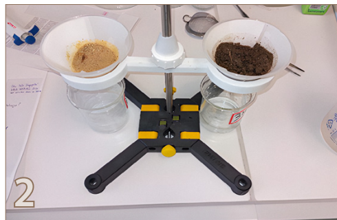
Abbildungen B 1-14 und B 1-15 Vergleich der Wasserspeicher- kapazität verschiedener Böden (Foto: Franziska Hanko)
